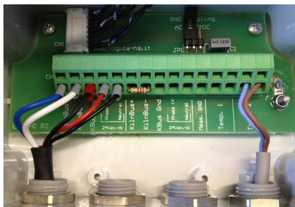
*Exemple d'insertion de résistance de terminaison sur le dispositif LG35*
