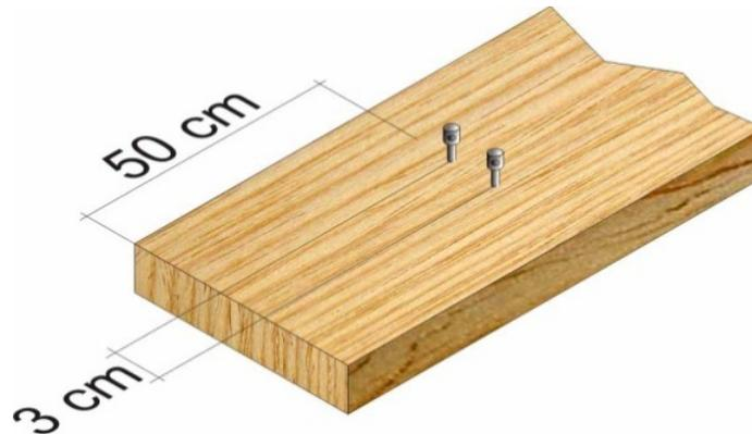
L'humidité du bois est relevée par le contrôleur en fonction de la résistance qu'il oppose au passage du courant entre les deux électrodes de mesure, qui doivent être insérées soigneusement dans les planches choisies comme échantillons.
