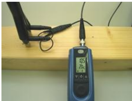
Illustration 4-1 Mesure réalisée à travers les fibres, avec M 20
