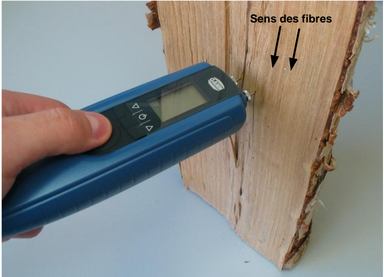
Figure 4-1 Mesure transversale par rapport au sens des fibres
